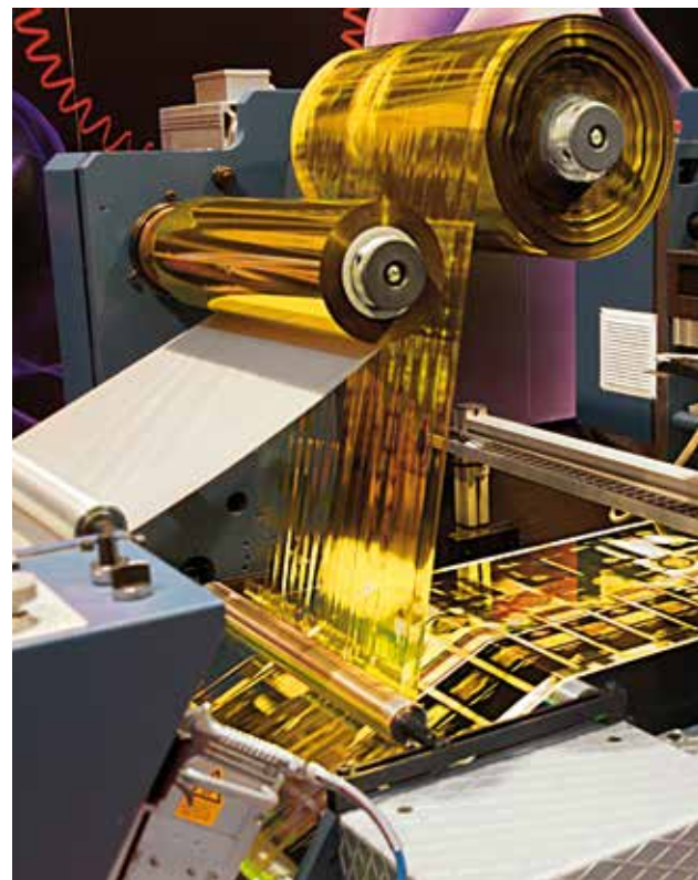
08 Smalbaan inlijn koudfoliedruk, af- en opwikkelunit. Links (niet zichtbaar) drukt en hecht de folie op de natte flexodruk.
