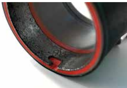
14 Opsluit-keep in adaptersleeve voor registerhandhaving.
