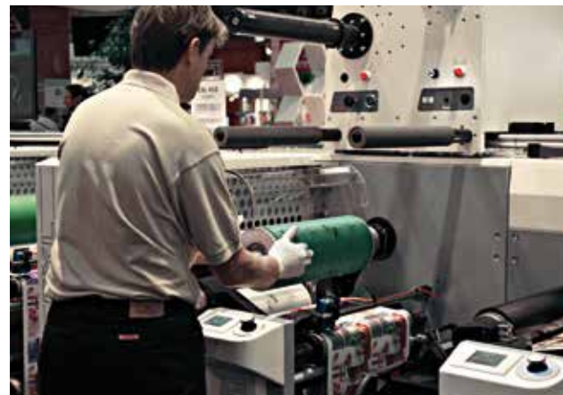
14 MPS' EXL sleeve-offsetpers wisselt rapportlengthe via plaat- en rubberdoek-sleeves met gewijzigde diameter.
