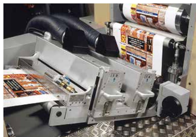
04 UV-droging geeft een milieu- en kwaliteit-boost aan fullcolour flexo-etikettendruk.
