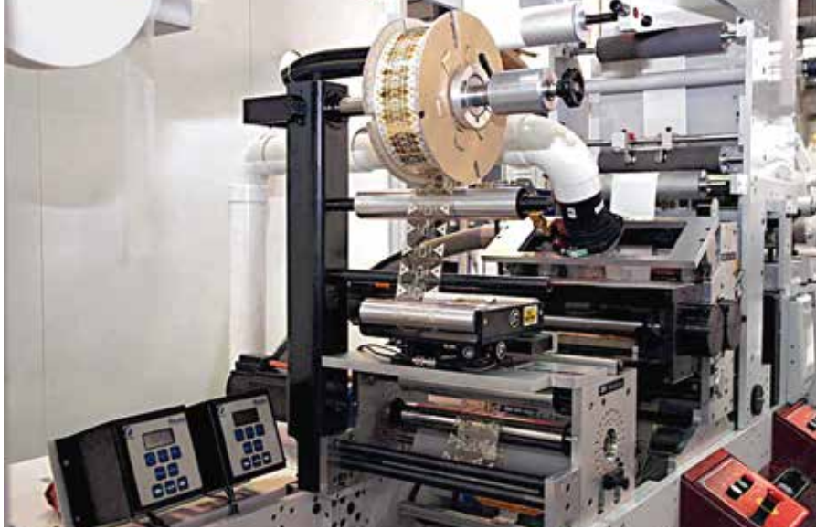
10 RFID-tags worden hier tijdens convertie op etiketten geplakt.
