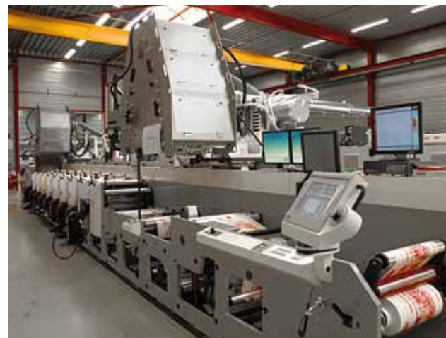
07 MPS’ hybride smalbaan EXL510-flexopers met uitgebreide converting. De opstaande delen zijn heteluchtdrogers.
