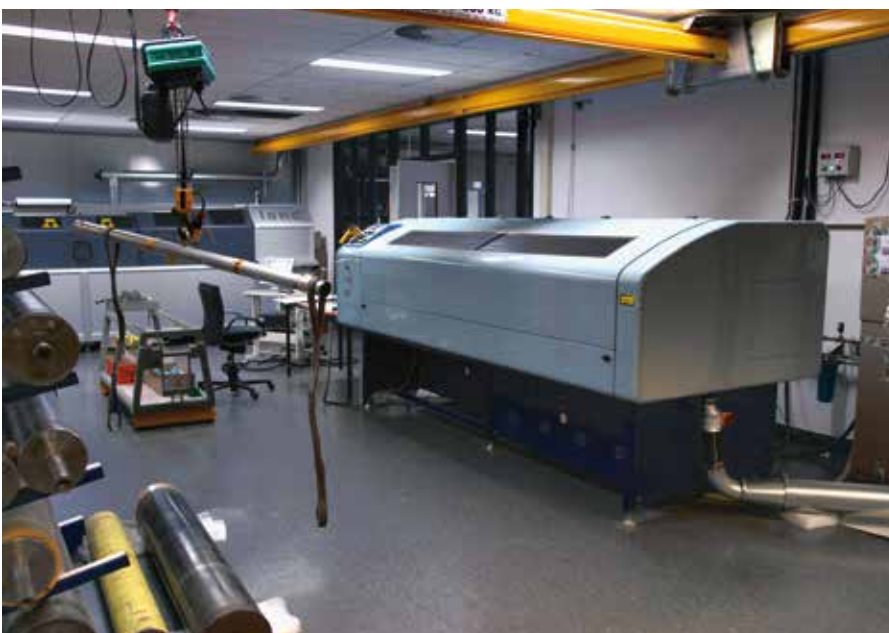
12 GRS werkt 24/5 met 7 lasergraveersystemen voor ronde drukvormen.
