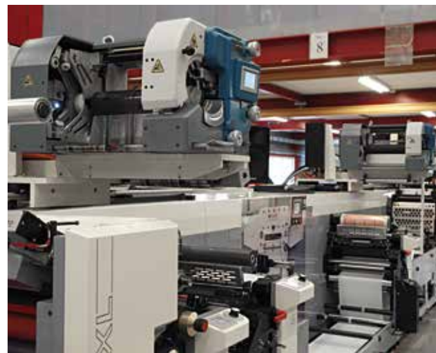
09 Bovenop de EXL510 een convertingrails met twee flexibel plaatsbare zeefdruk-insertunits.
