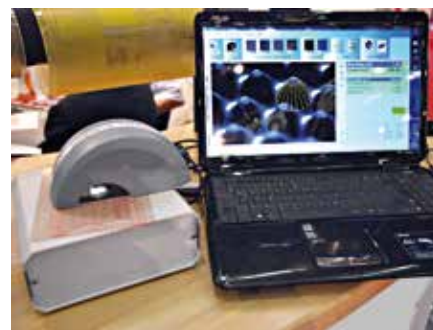
17 Sibress Universal Flexocontrol; links meetkop, rechts rapportagescherm.
